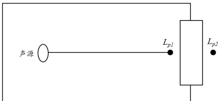
图 7.3-1 室内声源等效为室外声源图例
